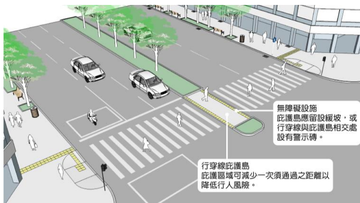
圖 4-3-11 行穿線庇護島設置案例
